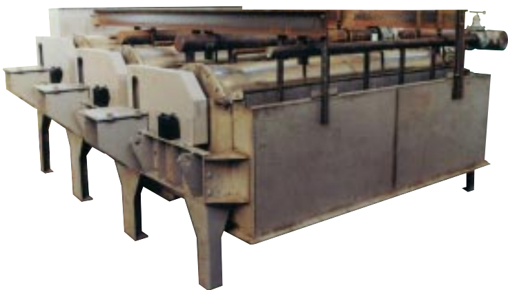
Appareil à 3 séparateurs voie humide type SLR 9/300.
